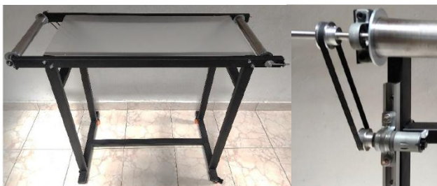
Fig. 12. Estructura de banda transportadora. Fuente: los autores
