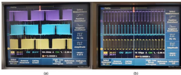
Figura 8. Terna de tensiones de columna, a la salida del inversor.
