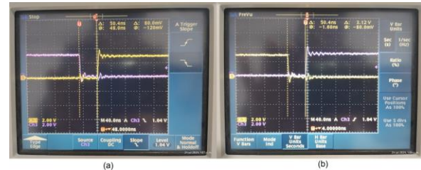
Figura 10. Señales de comando para una columna del inversor. Trazo violeta: para el transistor Q1, amarillo para Q4.
