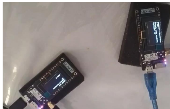
Fig. 6. Prueba de LoRa con dos placas de desarrollo TTGO LoRa32 2.1 1.6
