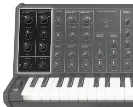
Fig. 2. Banco de osciladores del Korg MS-20.
