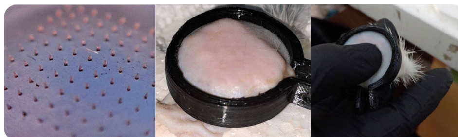
Figura 5. Visualización de matriz de microagujas moldeada en AH con colorante. Piel de rata extirpada y colocada sobre el bastidor. Aplicación de la matriz sobre la piel con el pulgar.
