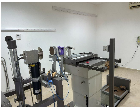
Figura 1: Equipo de rayos X y set up utilizado para las mediciones de coeficientes de atenuación lineal.
