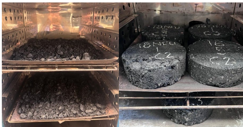
Figura 2. Envejecimiento de las mezclas a corto plazo (izq.) y largo plazo (der.)
