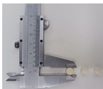
Figura 2: Medición de homogeneidad de tamaño y forma en impresos cilíndricos obtenidos con las distintas tintas.
