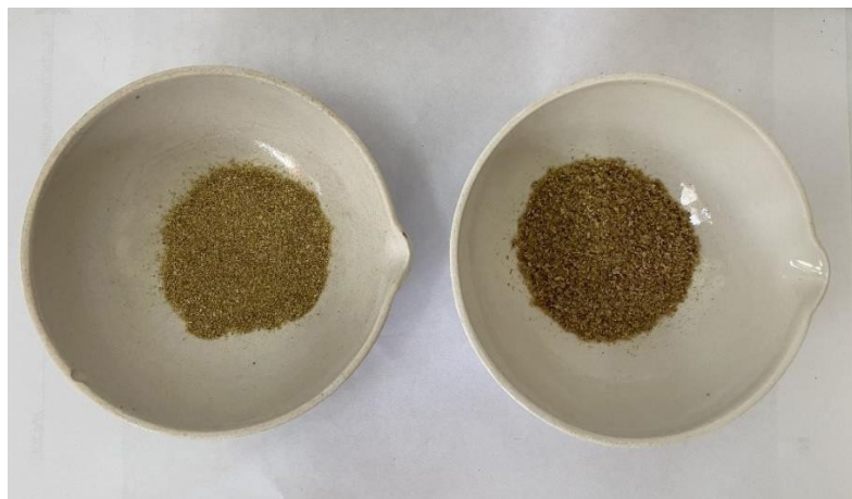
Figura 1: Burlanda lavada y secada a 80°C, tamizada en diferentes tamaños de partícula: (P) a la izquierda, (G) a la derecha.
