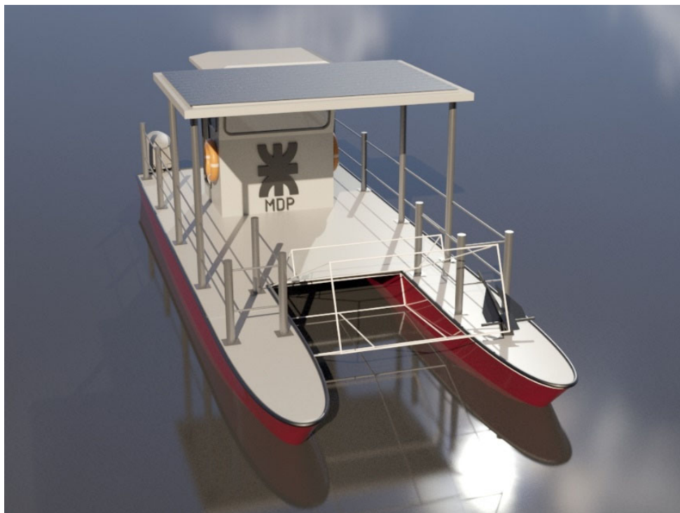
Fig. 3. Prototipo de buque de limpieza para el puerto de Mar del Plata.
