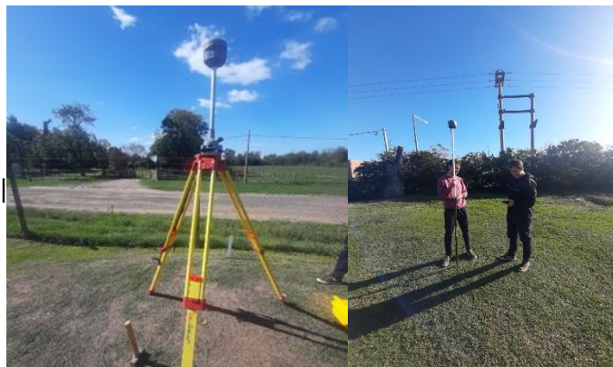
Figura 3.- A la izquierda, base del equipo GPS ubicado en el Polo Club, donde se encuentra instalado uno de los freatímetros. A la derecha, equipo del Equipo del Laboratorio de Medio Ambiente realizando nivelación con GPS.
