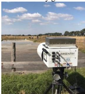
Figura 5. Equipo de medición de GEI por FTIR
