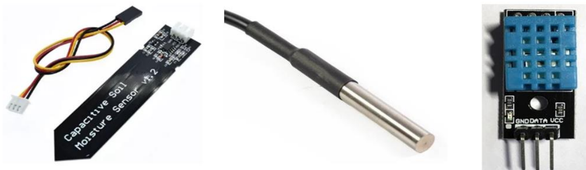
Figura 1, 2 y 3. Sensor de humedad v1.2, sensor de temperatura Bs 18b20 y sensor de humedad y temperatura DHT11 respectivamente.
