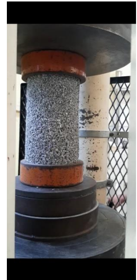
Fig.N°6: Rotura a compresión
