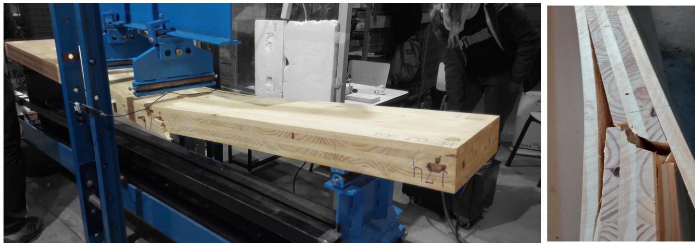
Figura 8 y 9. Rotura de la probeta N°2. Falla por flexo-tracción.
