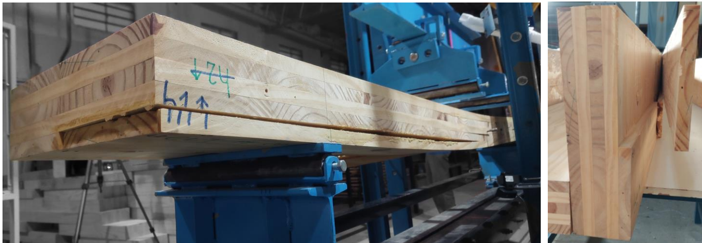
Figura 6 y 7. Rotura de la probeta N°1. Cizalle longitudinal. deficiente unión encolada.
