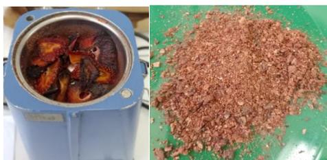
a) láminas deshidratadas b) láminas molidas
