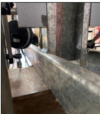
Figura 10: Deformación en probeta "T" luego del ensayo a compresión
