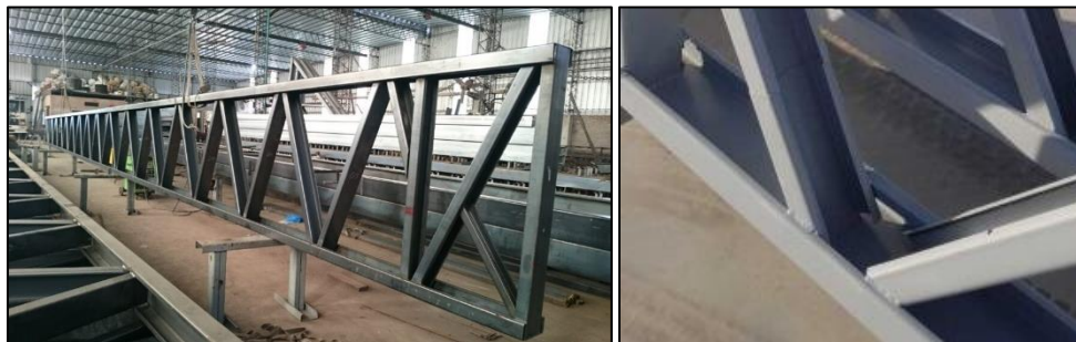
Figura 1: Viga Reticulada con PFC - Unión soldada
