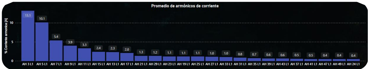
Figura N° 3 – Componentes armónicos de la corriente del acondicionador de aire inverter
