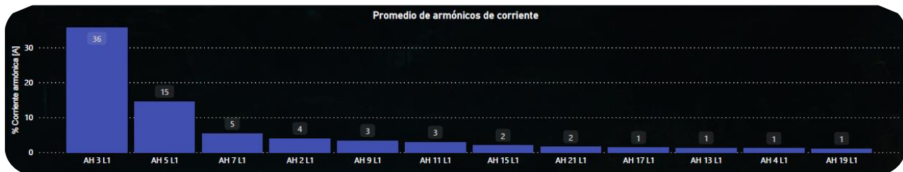
Figura N° 15 – Componentes armónicos de la corriente del microondas
