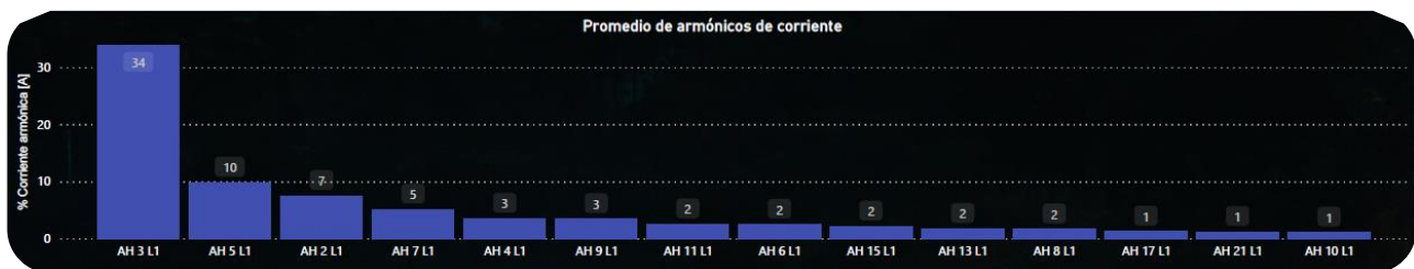
Figura N° 12 – Componentes armónicos de la corriente del lavarropas
