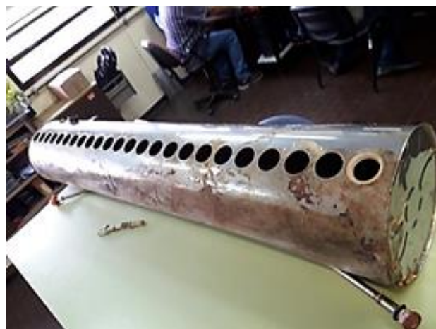
Figura 2: cuerpo del tanque sin la cobertura y material aislante
