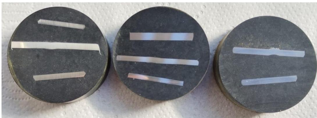
Figura 3: Inclusiones de las probetas “Buena”, “Intermedia” y “Mala” respectivamente.
