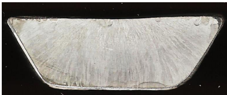
Figura 3. Imagen macrográfica de una sección transversal del lingote.
