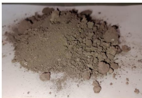
Figura 7: Aspecto de la escoria posterior al proceso de recuperación.
