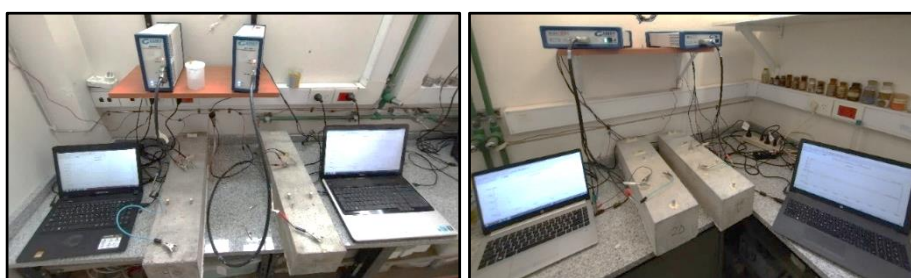
Figura 3 – Mediciones en probetas utilizando potenciostatos/galvanostatos GAMRY®.
