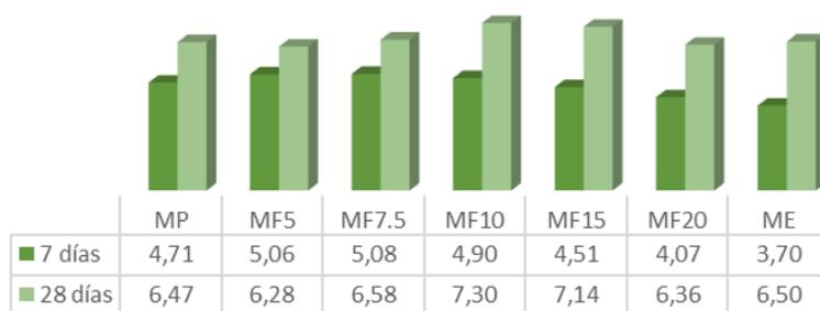
Figura 17: Resistencia a flexión [MPa] a 7 y 28 días.
