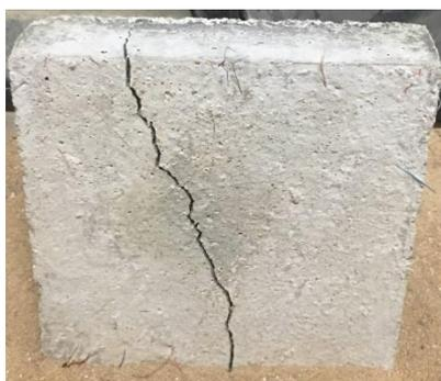
Figura 16: Rotura por impacto en probetas con fibras plásticas.
