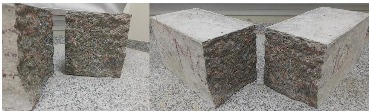
Figuras 14 y 15: Rotura por flexión en vigas con fibras plásticas.
