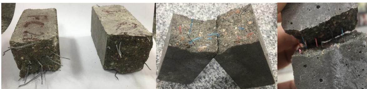
Figuras 8, 9 y 10: Roturas a flexión de fibras de acero y plásticas.
