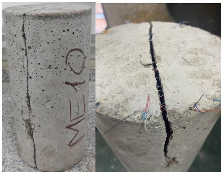
Figuras 12 y 13: Rotura por tracción a compresión diametral en probetas con fibras plásticas.
