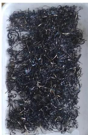
Figura 7: Fibras de acero seleccionadas.
