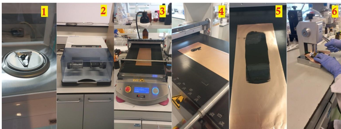
Fig. 3: Proceso de elaboración de pinturas anódicas y catódicas.
