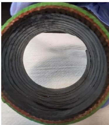
Figura 2. Cara interior del extracto de manguera
