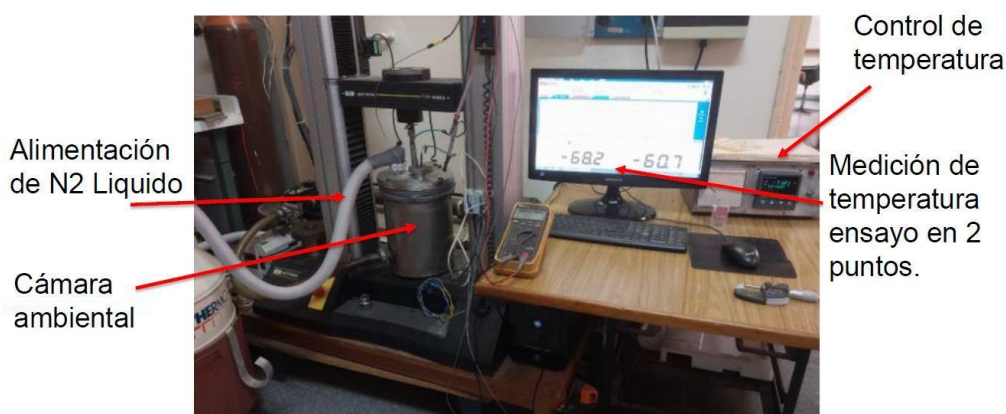
Figura 4: Máquina de ensayo SPT con cámara ambiental.
