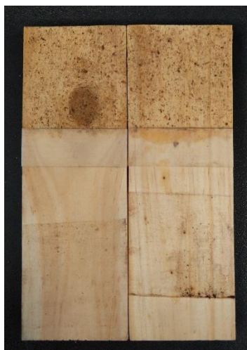
Figura 4: Probeta de ensayo de corte ya testeada, en donde se puede apreciar la ruptura cohesiva del adhesivo
