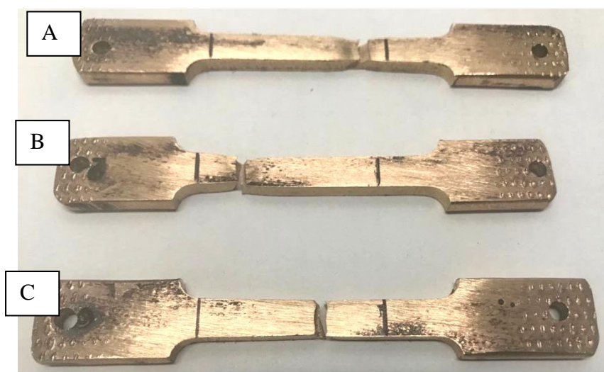
Figura 5: probetas utilizadas para los ensayos de tracción, (A) envejecida durante 1 hora, (B) 2 horas y (C) 3 horas; en esta última muestra se observa la escasa formación del cuello (proveniente de la estricción del material), lo que concuerda con la mínima ductilidad encontrada en los valores del ensayo.
