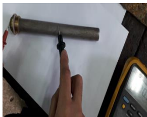
Figura 2: Medición de la conductividad en ánodo.
