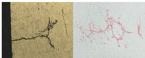
Figura 5: Fisuras por SCC, transgranular ramificada. Figura 6: Ensayo “END” por líquidos penetrantes.
