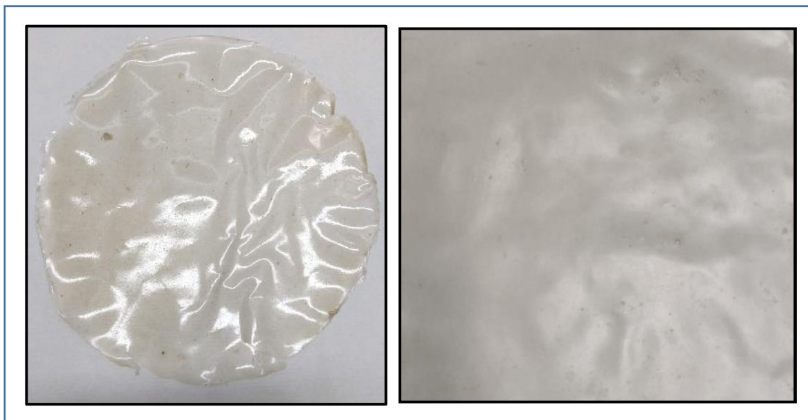
Figura 3. Imágenes de biopolímero sintetizado por método casting.
