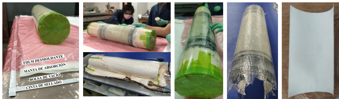
Figura 3: Laminación de un álabes.
