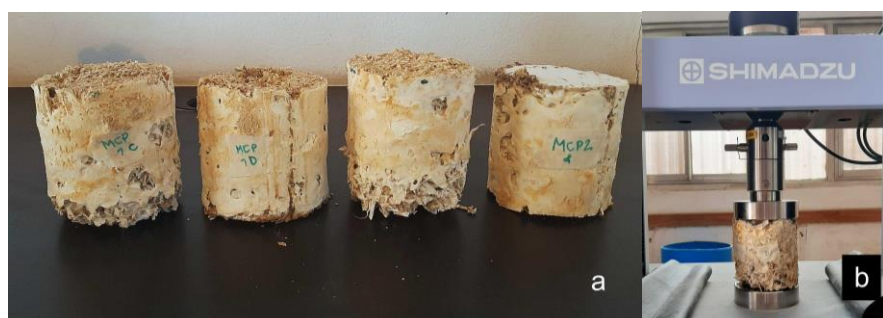
Figura 1. a: Muestras para ensayo de resistencia a compresión. b: Ensayo de resistencia a compresión.
