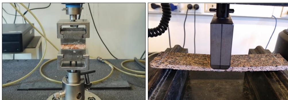
Figura 3. Ensayos mecánicos de los tableros de partículas. Tracción perpendicular a las caras (izq.); Flexión a tres puntos (der.).
