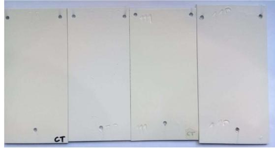
Figura 19. Ejemplo de probetas después del ensayo de ciclado térmico.
