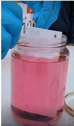
Figura 12. Inmersión de probeta en el agente químico I.
