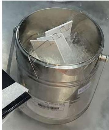
Figura 13. Inmersión de probeta en el agente químico II.
