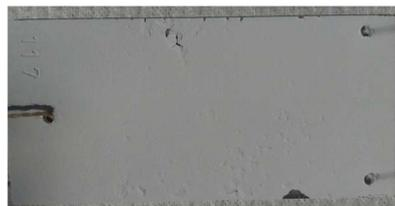
Figura 17. Aluminio 6061T6, luego de inmersión en alcohol isopropílico.
