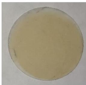
Figura 3: Filtro de muestra 2 (Diésel en contacto con aire)
