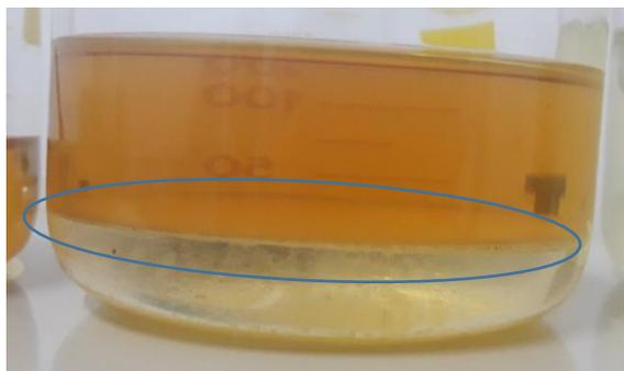
Figura 1: Interfase Diésel y Agua en muestra N° 3.
