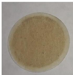
Figura 4: Filtro de muestra 3 (Diésel en contacto con agua y aire)
