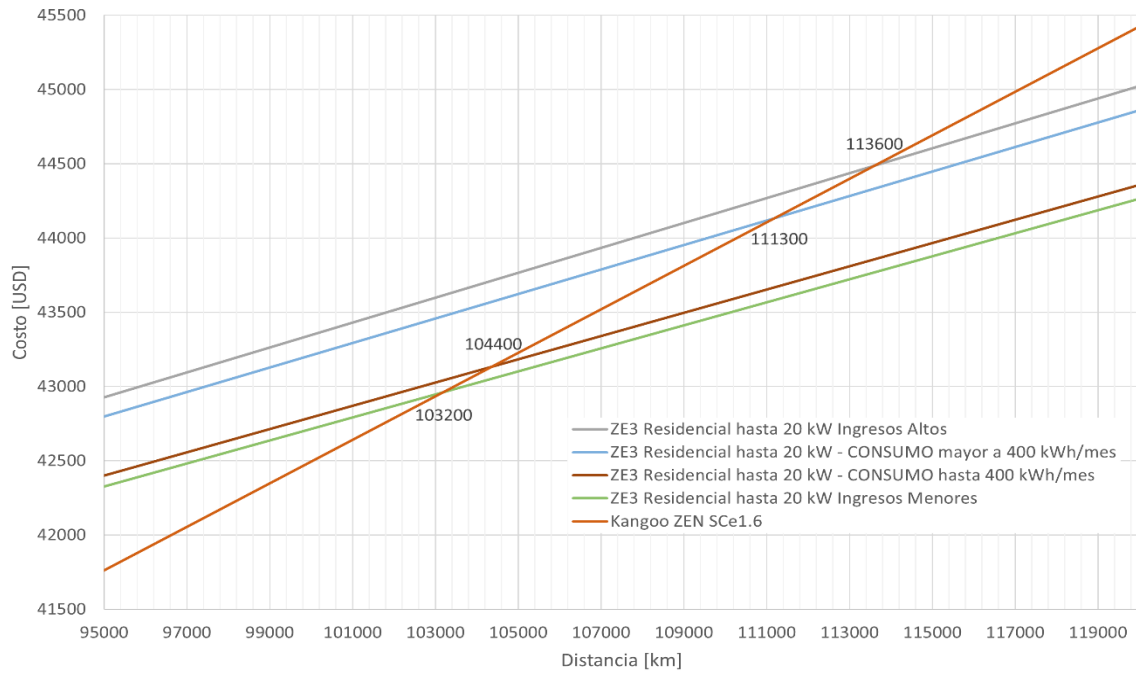
Figura 3. Evolución del costo acumulado para cada segmento tarifario en un escenario Kangoo ZE 3.
