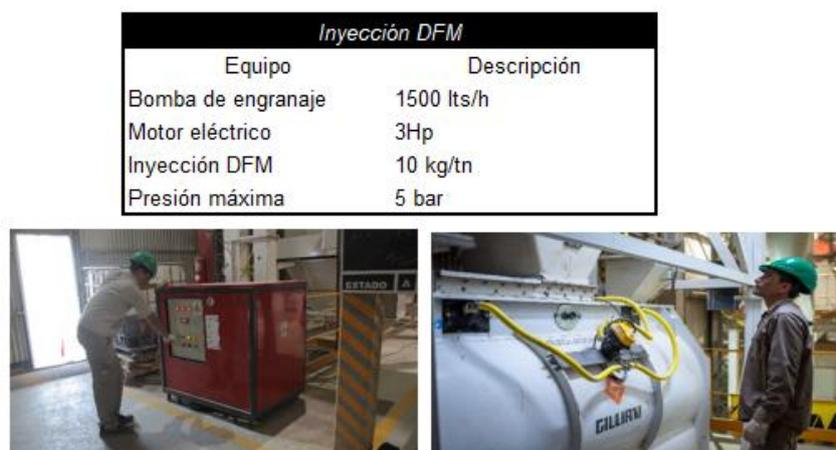
Figura 1. Equipo para la inyección automática de DFM Clúster Industrial
