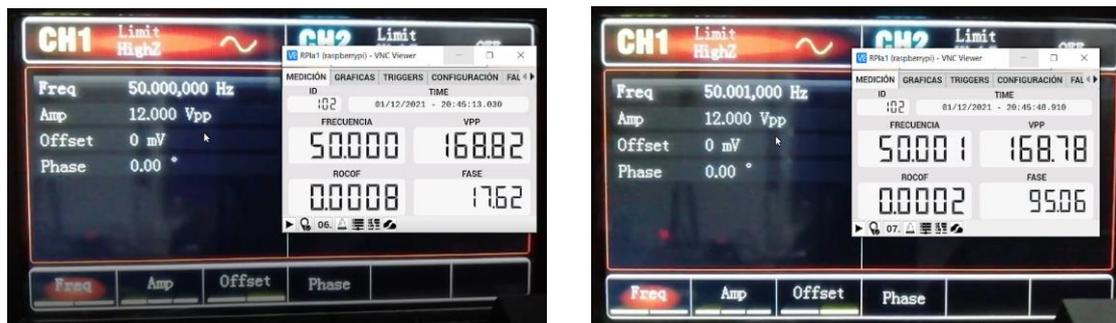
Figura 3. Ensayo frecuencia, (izq) 50.000 Hz y (der) 50.001 Hz.
