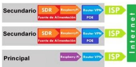
Figura 2. Diagrama en bloques del sistema
