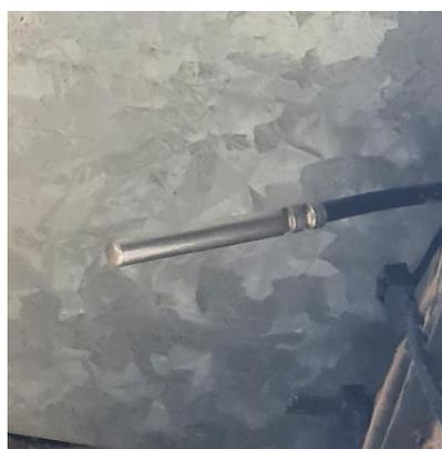
Figura 1d: Sensor de temperatura ambiente
