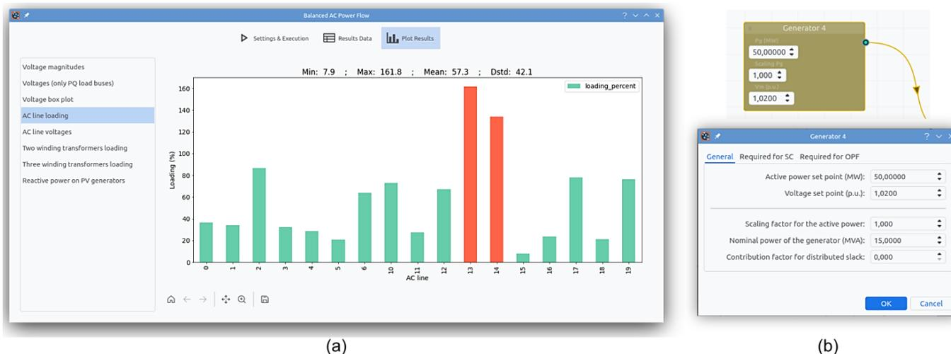
Figura 3. (a) Ventana de simulación (cálculo de flujo de potencia). (b) Parametrización de un nodo en el grafo.
