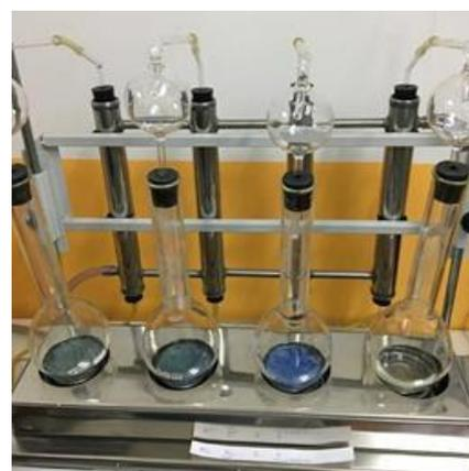
Figura 3: Destilación de muestra digerida
