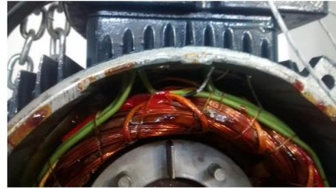
Figura 2 - Ubicación de las Termocuplas en los bobinados
