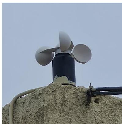
Figura 1b: Medidor de velocidad de viento
