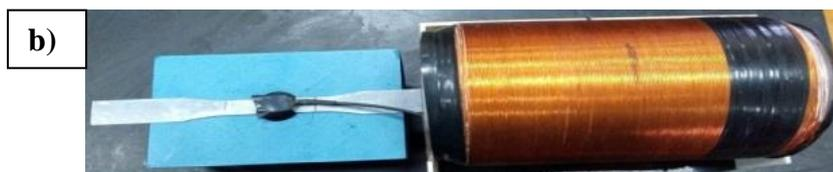
**Figura 3.** a) Fotografía del sistema de medición experimental del RMB; b) Detalle de la colocación del sensor de RMB sobre la probeta.
