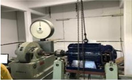
Figura 1 - Motor en Banco de pruebas
