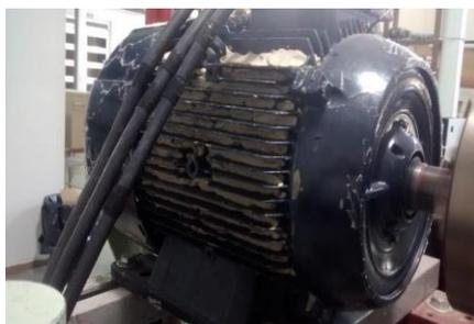
Figura 5 - Detalle del 50% de los álabes tapados
