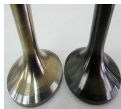
Figura 3: válvulas con C/N y sin proceso de nitrurado S/N
