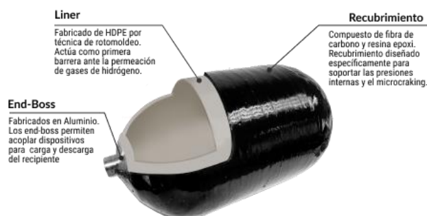
Figura 1: Esquema del primer prototipo de tanque tipo IV fabricado en INTEMA.
