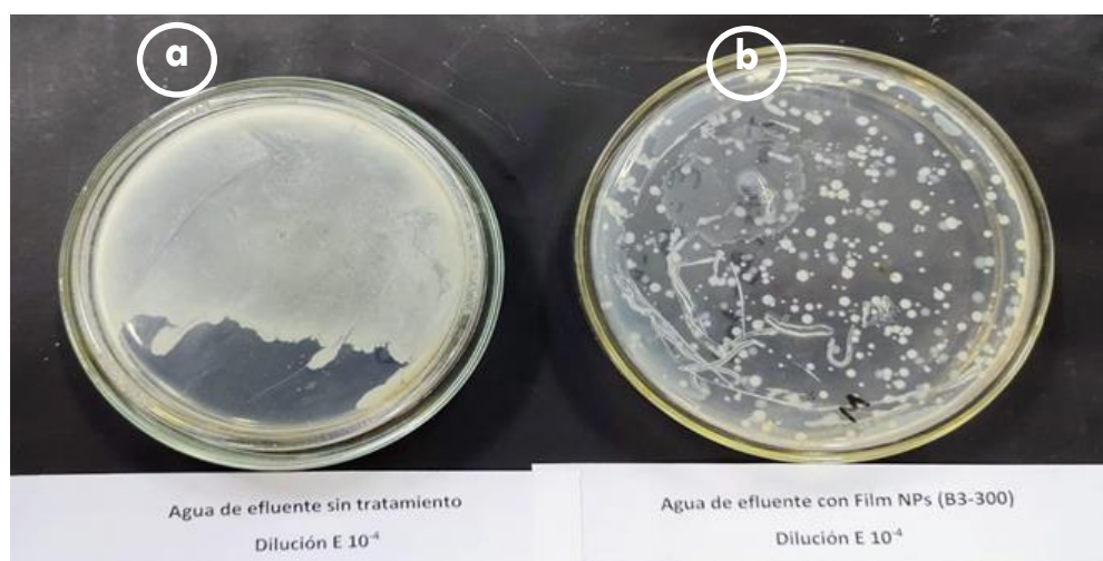
Figura 1: Recuento en placa con efluente: a) Tratamiento con Film-C; b) Tratamiento con Film-NPs.
