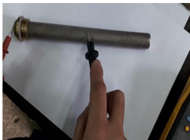
Figura A: medición de la conductividad del contacto eléctrico del ánodo de magnesio y la rosca de bronce de \frac{3}{4} ", mediante un multímetro.
