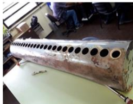
Figura 2: cuerpo del tanque sin la cobertura y material aislante.
