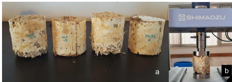
Figura 1. a: Muestras para ensayo de resistencia a compresión. b: Ensayo de resistencia a compresión.
