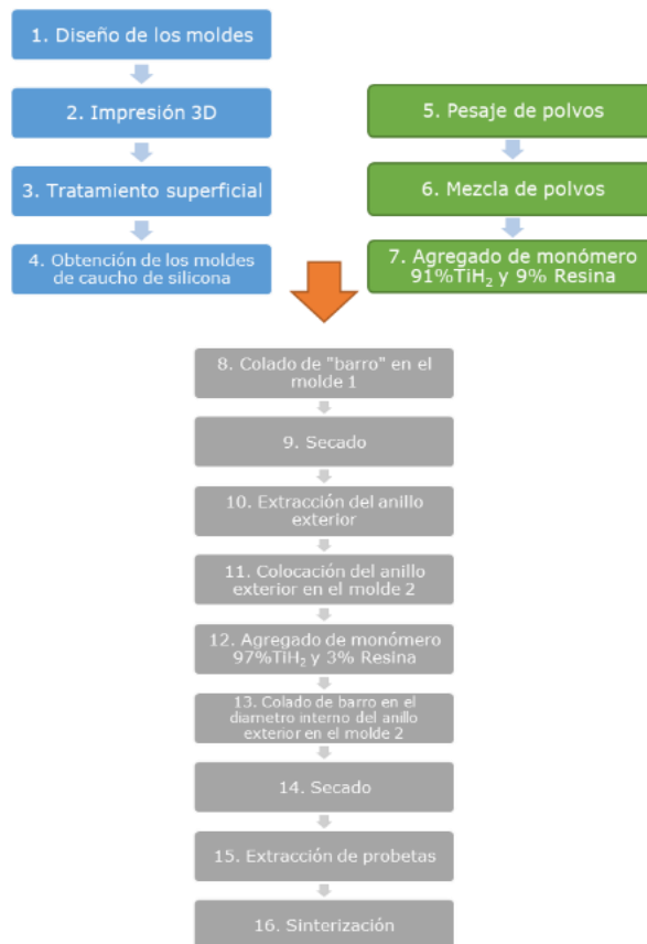
Figura 1: Proceso para la obtención de estructuras con porosidad gradual por Gel-Casting y sinterización.
