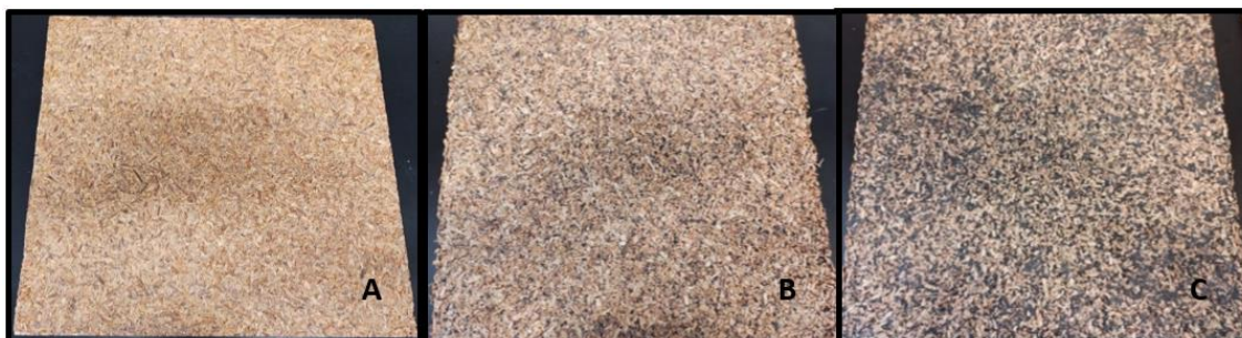
Figura 1. Tableros de partículas fabricados con residuos de cuero en su composición. A) 100/0; B) 90/10 y C) 80/20.
