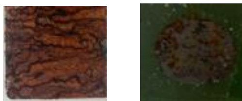
Figura 2. Las placas de acero sin y con el revestimiento, a la derecha se observa una notable protección contra la corrosión por WBPU-DA.
