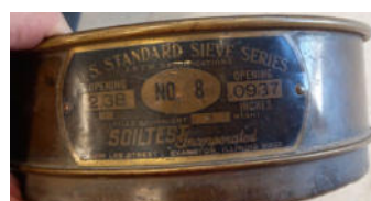
Figura 7: Tamiz N°8 utilizado para la preparación de la arcilla.
