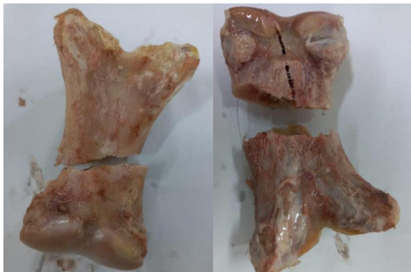
Figura 5: Estado final de las falanges proximales N° 13 y N° 15 sometidas a flexión en tres puntos con sus sitios de rotura.
