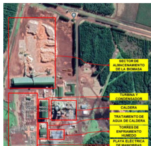
Figura 1: Vista aérea de la central termoeléctrica FRESA con detalle las diferentes etapas del proceso
