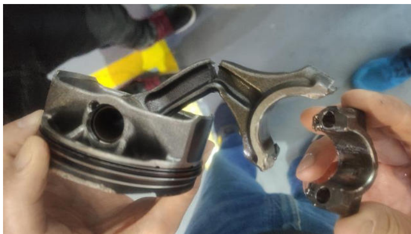
Figura 1: Biela quebrada y cabeza desacoplada.
