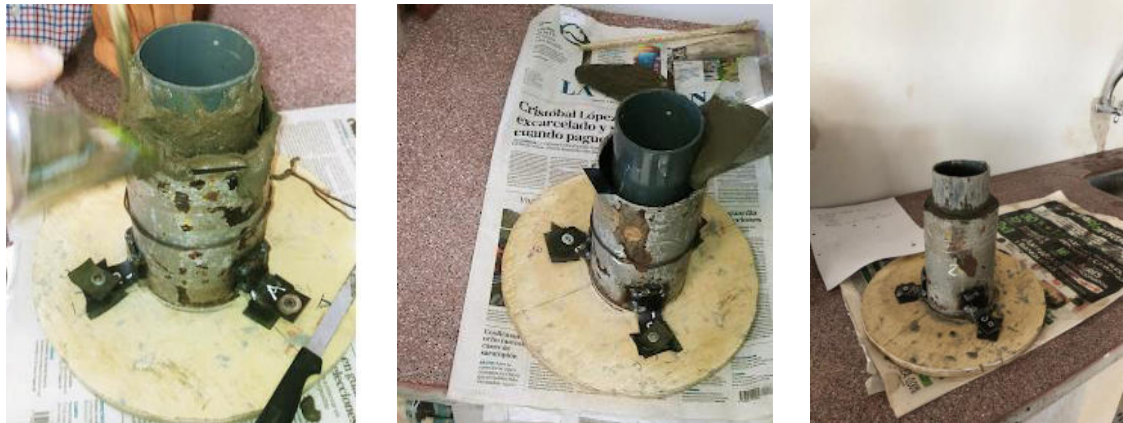
Figura 3: Fabricación del cilindro núcleo
