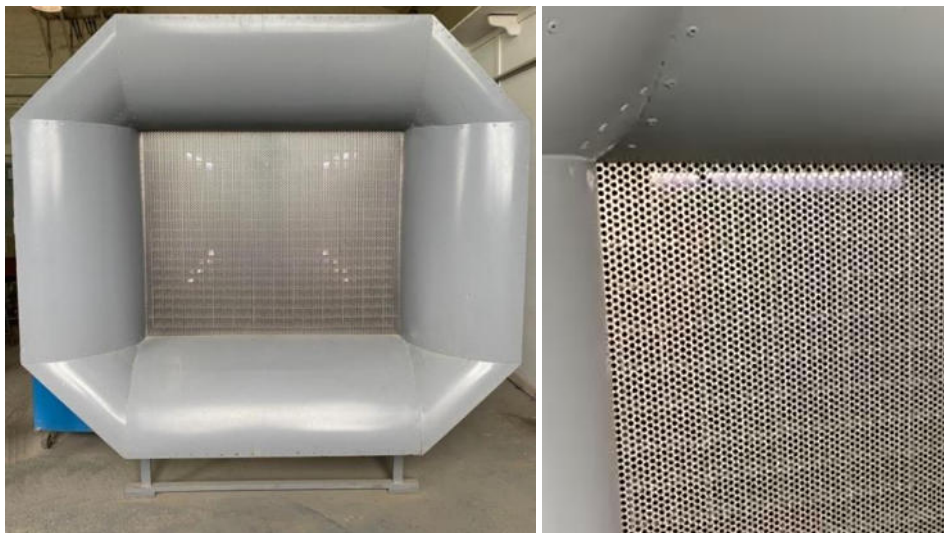
Figura 4: Pantalla ensayada. Diámetro agujeros: 5mm. Relación de Bloqueo: 0,5.
