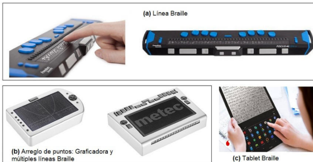
Figura 2: Clasificación de dispositivos Braille por su funcionalidad.
