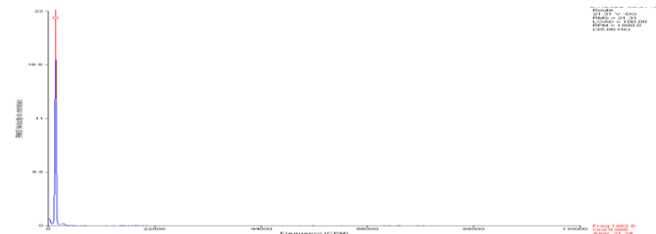
Figura 4: Espectro en velocidad vibratoria del motor, dirección vertical lado acople.
