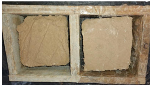
Figura 17: Contracción volumétrica notoria en muestras para el ensayo de absorción de agua.
