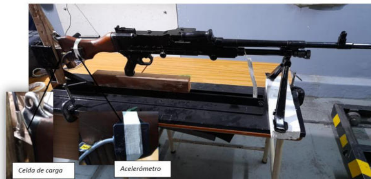
Figura 9. Ubicación del acelerómetro y la celda de carga durante el ensayo.
