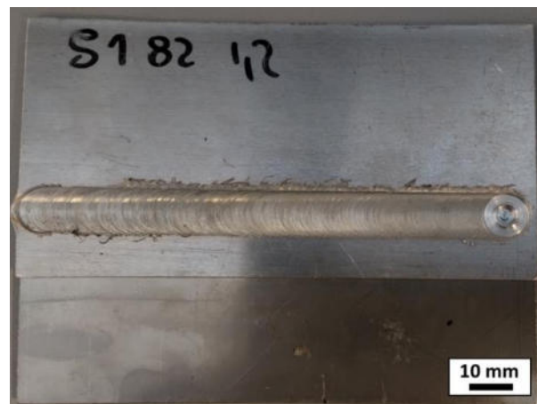
Figura 7: Aspecto superficial de una unión AA5182-O – AISI 304L
