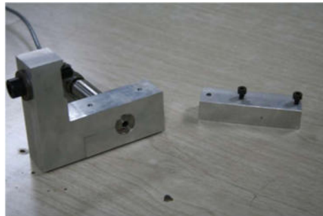
Figura 5: Dispositivo de montaje del LVDT.
