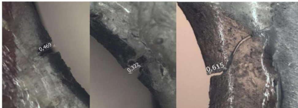
Figura 3. Medición de fisuras (mm) en cuerpos de prueba de Aluminio 6063-T5.
