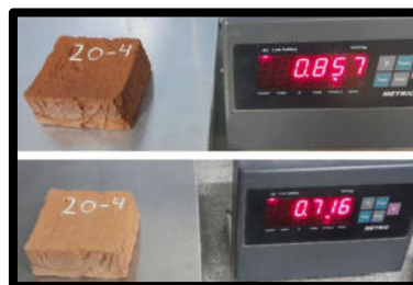
Figura 3: Diferencias de peso en la probeta debidas a su estado saturado; y su estado seco.
