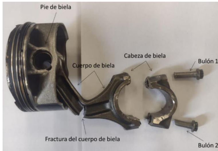
Figura 5: Conjunto de biela y pistón dañados.
