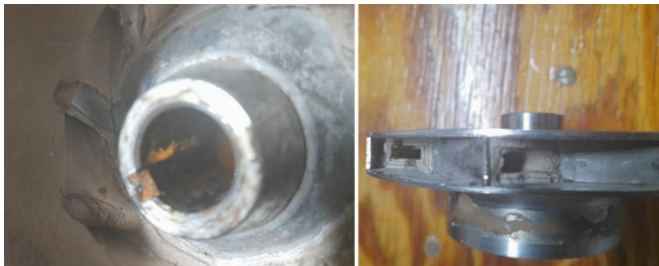
Foto 3: Aspecto de Bloqueo en Impulsor de BC
