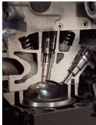
Figura 2. Sensor de pressão montado na câmara de combustão de um motor.
