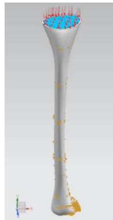
Figura 4: Disposición de cargas y restricciones para la tibia sin intervención.
