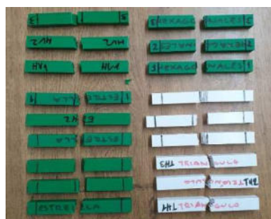
Figura 13: Zona de rotura de las probetas testeadas
