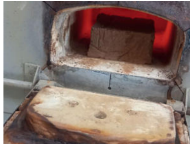
Figura 10: Proceso de cocción en mufla eléctrica a 750 °C.
