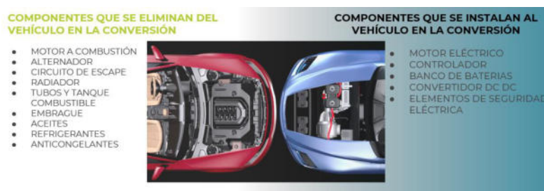
Figura 12: Comparación entre un VCI y un vehículo VEB. [5]
