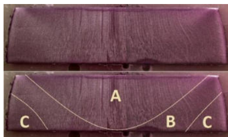
Figura 2: Identificación de diferentes zonas (según nivel de deformación) en la sección media longitudinal de la muestra tratada a 350°C, deformada un 50% por compresión.
