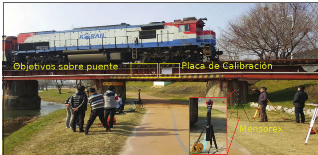
Figura 1. Disposición de los elementos para realizar los ensayos estáticos y dinámicos
