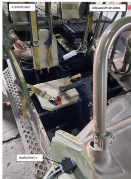
Figura 6. Instalación del equipamiento para medir las aceleraciones en el vehículo Polaris MRZR-4.
