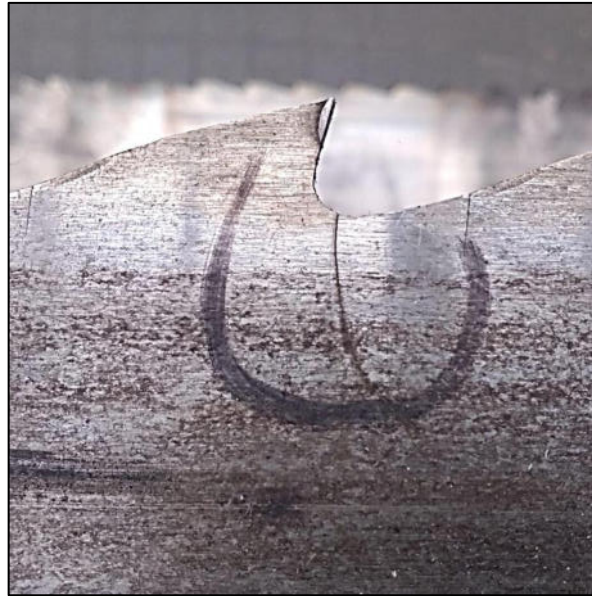
Figura 6: Fisura en garganta de sierra.
