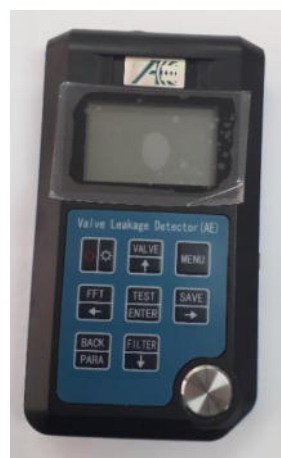
Figura 2: Equipo portátil de EA para detección de fugas en válvulas
