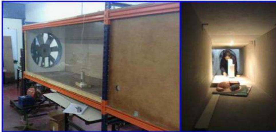
Figura 9. Túnel de viento del LaDiFA utilizado en este trabajo.
