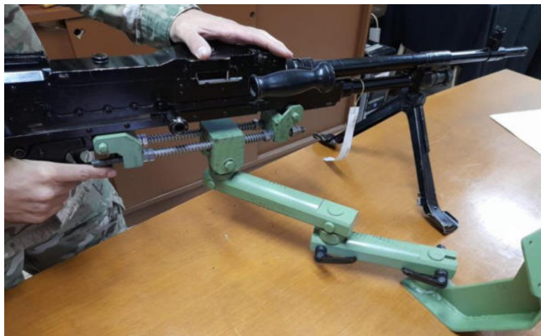
Figura 3. Ametralladora MAG calibre 7,62 mm. montada en soporte diseñado
