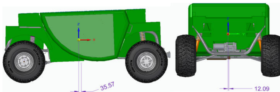
Figura 10: Ubicación del acelerómetro en el vehículo
