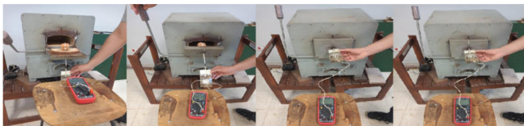
Figura 4: Imagen ilustrativa del proceso de colocación de la muestra en la mufla eléctrica.
