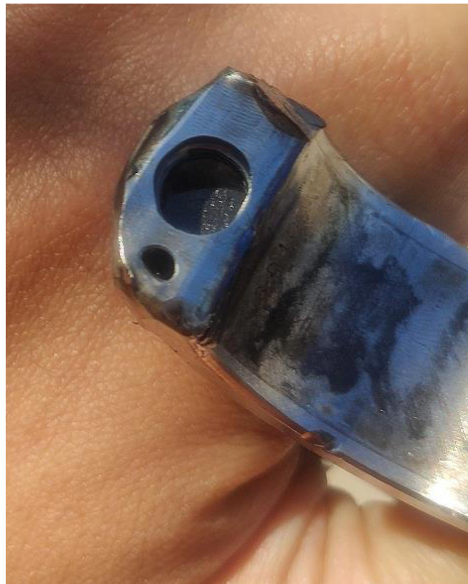
Figura 4: Falla en el bulón probablemente por fatiga.
