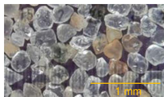
b. \phi 250 \mu\text{m} . 94^\circ < \mathcal{A} < 106^\circ
