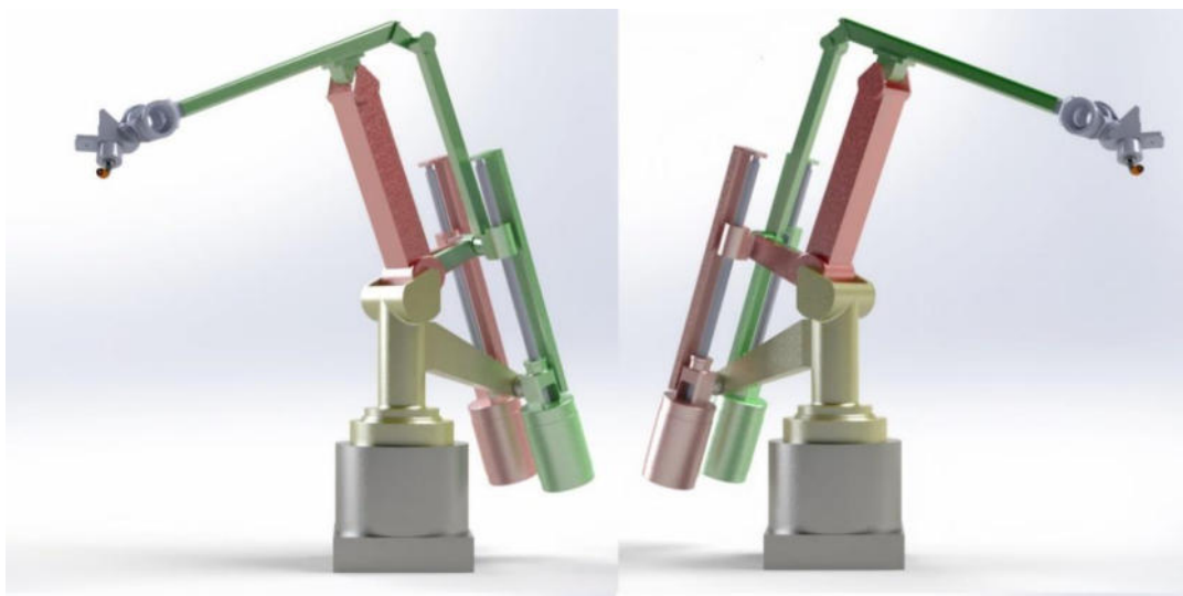
Figura 3: Posiciones inicial y final de la torcha para los movimientos simulados
