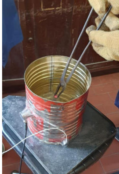
Figura 2: Proceso de enfriamiento de temple
