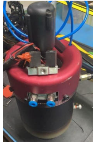
Figura 6: Nueva pieza con conexiones FESTO para la entrada de H 2 a la turbina
