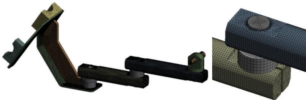
Figura 11. Discretización geométrica y detalle de mallado.
