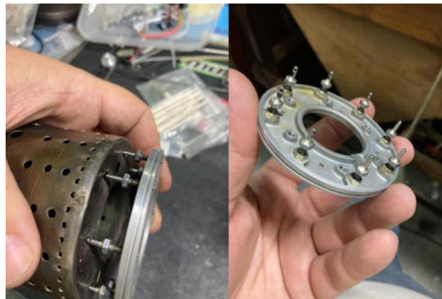
Figura 8: Nuevos inyectores montados en la cámara de combustión con su nueva disposición
