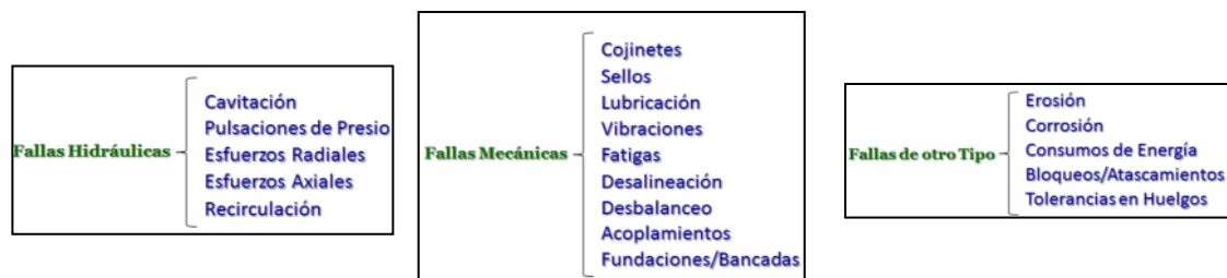
Figura 1: Distintos tipos de fallas en BC
