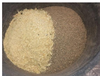
Figura 2: Diferenciación del aserrín y la arcilla antes de iniciar el proceso de mezclado.
