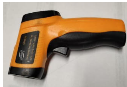
Figura 2: Termómetro digital por infrarrojo. Fotografía de los autores.
