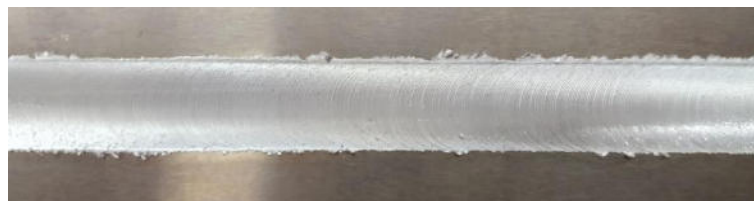
Figura 3: Aspecto superficial de unión soldada por FSW
