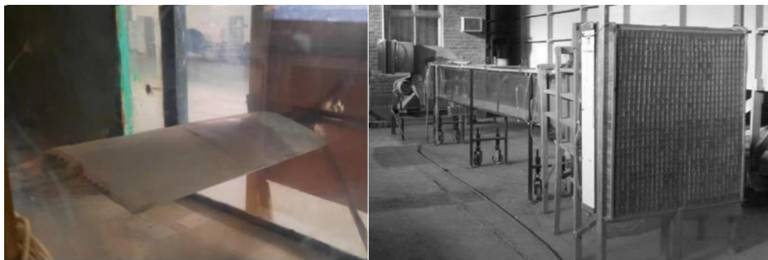
Figura 1: Perfil NACA 4412 y túnel de viento TV2.
