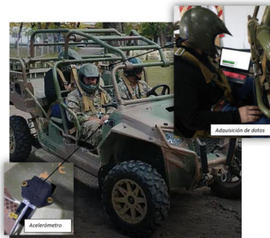
Figura 7. Ubicación del acelerómetro durante el ensayo.
