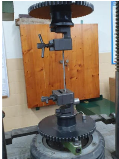
Figura 1: Montaje del cable en la máquina de ensayos. Se observan los sensores de EA
