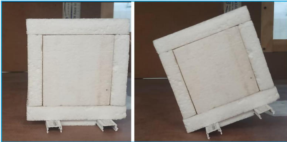
Figura 11. La velocidad crítica para el vuelco del tráiler se determina cuando este comienza a girar, como en la ilustración.
