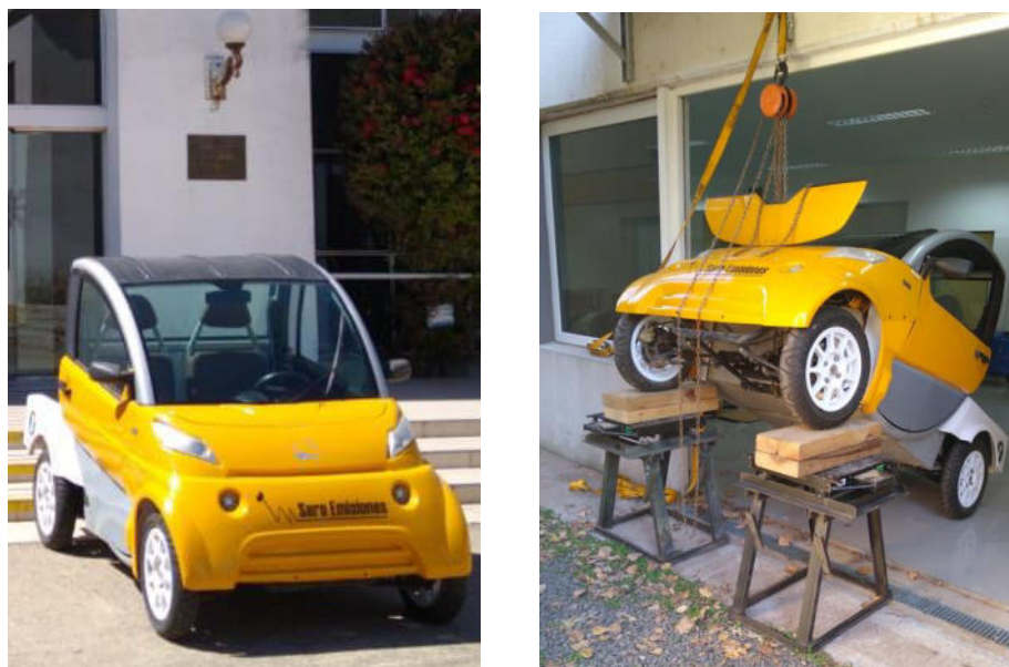
Figura 1: (a) Vehículo estudiado; (b) Ensayo para encontrar la ubicación vertical del baricentro
