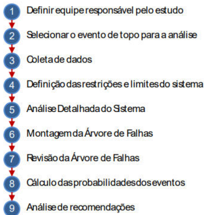
Figura 1: Fluxograma da sequência de procedimentos da FTA [4].
