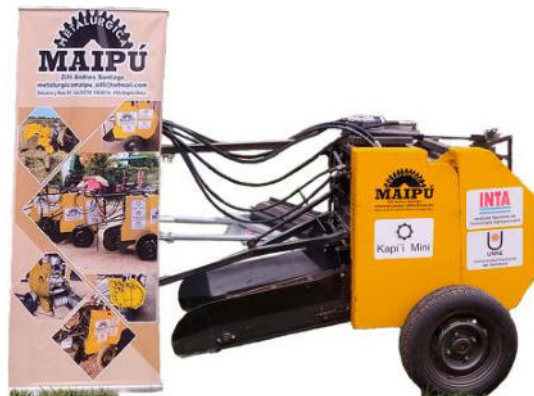
Figura 1: Rotoenfardadora UNNE-INTA Fuente: Metalúrgica Maipú
