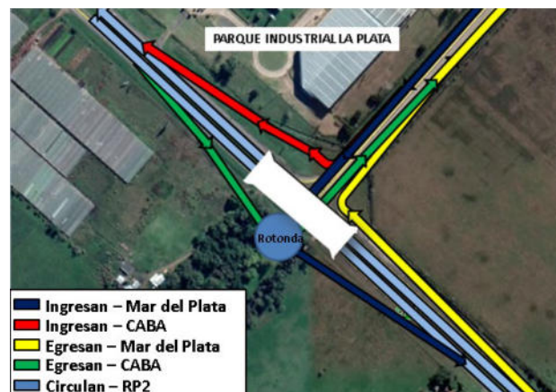
Figura 7: Esquema de la propuesta de vialidad para el cruce de la Rp 2 con la Av 520.
