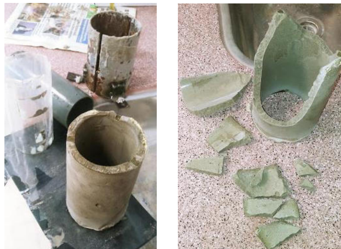
Figura 4: Rotura del cilindro núcleo
