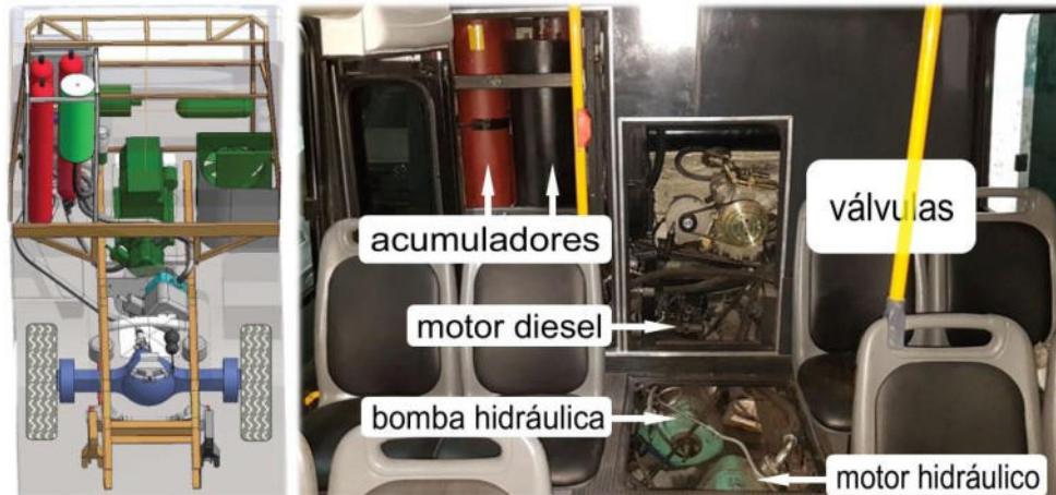
Figura 1: Distribución general de los componentes e implementación
