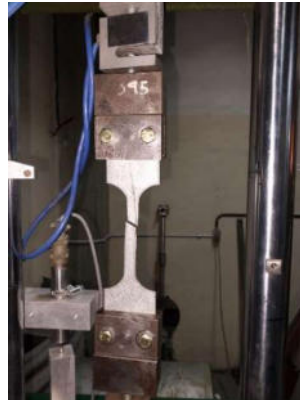
Figura 14: Probeta y mordazas modificadas luego de un ensayo de tracción.
