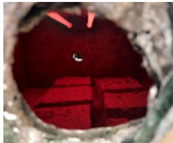
Figura 9: Secado de las probetas en estufa a 105 °C.
