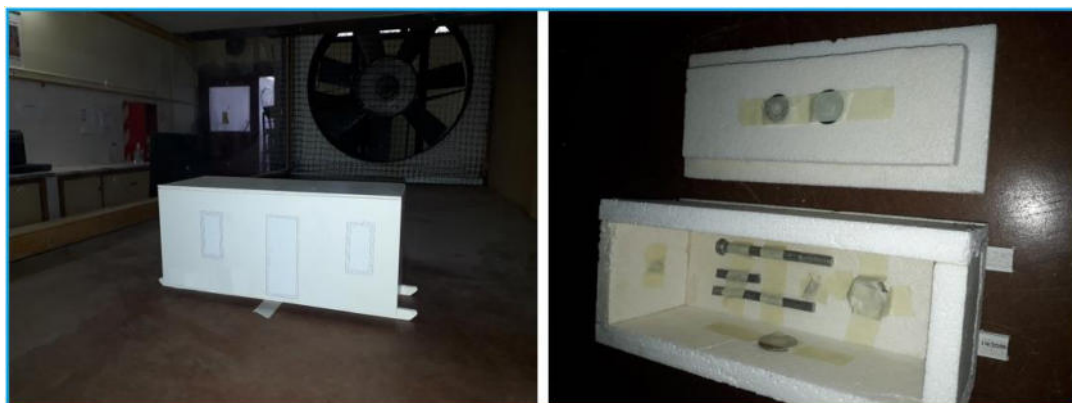
Figura 10. Izquierda modelo original, derecha modelo de ensayo con distribución de pesos según la escala de fuerzas calculada.
