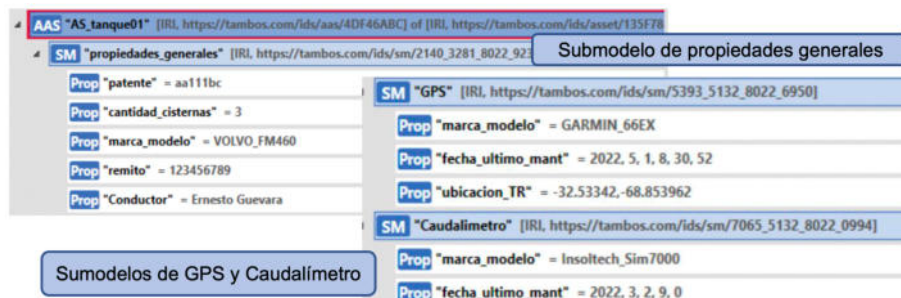
Figura 4: Submodelos propiedades generales, GPS, y Caudalímetro
