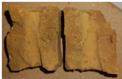
Figura 16: Apreciación de los poros internos en una muestra de resistencia al fuego con 10% de aserrín.
