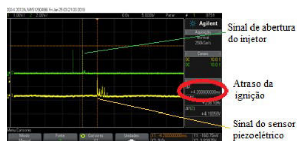
Figure 6. Aparência dos sinais do sensor piezoelétrico e abertura do injetor .
