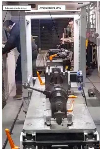
Figura 8. Ensayo de la fuerza de retroceso de una ametralladora.
