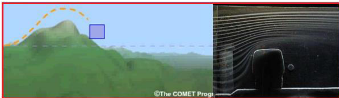
Figura 7. Similitud del viento pasando sobre una montaña y un vehículo en reposo.
