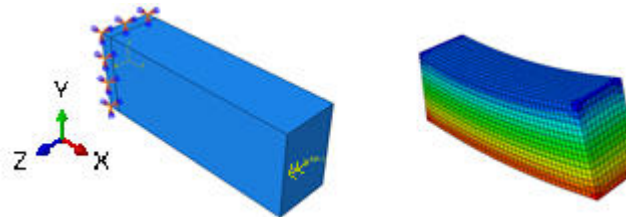
Figura 3: Viga sometida a flexión normal
