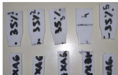
Figura 10: Zona de rotura de las probetas testeadas
