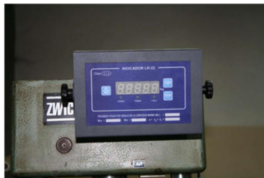
Figura 3. Indicador de carga montado en la máquina de ensayos.
