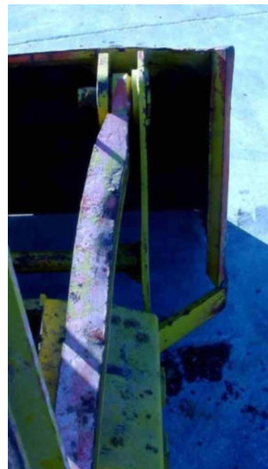
Figura 3: Parte inferior de la biela fracturada
