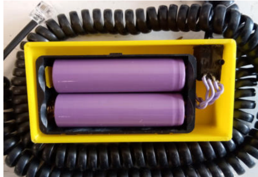
Figura 7: Baterías de alimentación.
