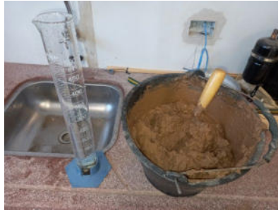
Figura 8: Proceso de mezclado húmedo del aserrín y la arcilla.
