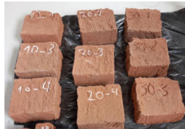
Figura 5: Probetas realizadas para el ensayo de absorción de agua.
