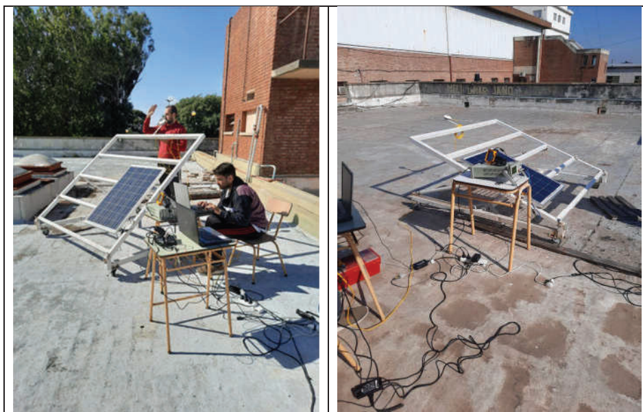
Figura 2. Plataforma ajustable para ensayos de paneles fotovoltaicos.
