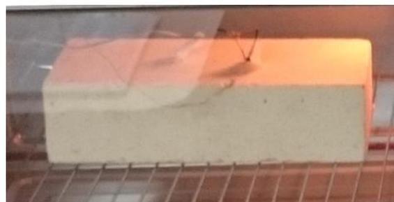
**Figura 4: posicionamiento de los termopares.**
