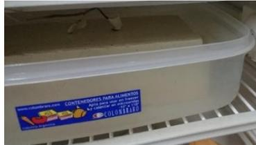
**Figura 1: Ladrillo sumergido en agua potable a  $(5 \pm 2)^\circ\text{C}$ ,**
