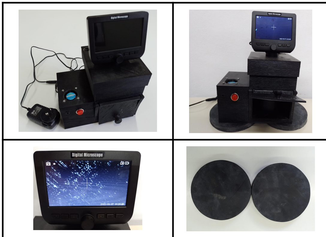
Figura 1: Prototipo empleado en el ensayo de speckle dinámico.
