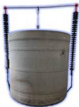
Figura 1: Tanque de agua con aisladores para ensayo de liner en Alta Tensión.
