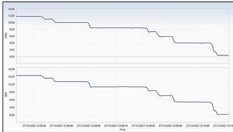
Figura 6: Registro en función del tiempo de los valores TrueRMS de tensión [V] (sup.) y corriente [A] (inf.) del lado primario del transformador TV001.
