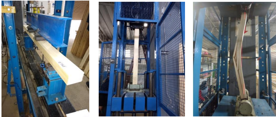
IMÁGEN 1: Máquinas de ensayo y elementos de prueba a flexión y compresión centrada, laboratorio UTN FRVT
