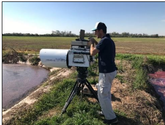
Figura 7. Muestreo de GEI a partir de equipo FTIR
