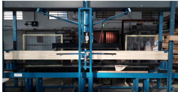
Figura 1: Viga laminada encolada de pino ponderosa sobre equipo de ensayos.
