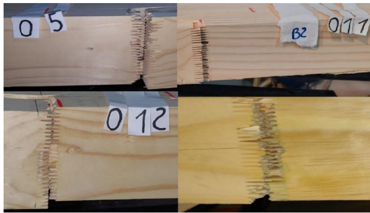
Figura 4: Rotura por falla de encolado en unión finger joint .
