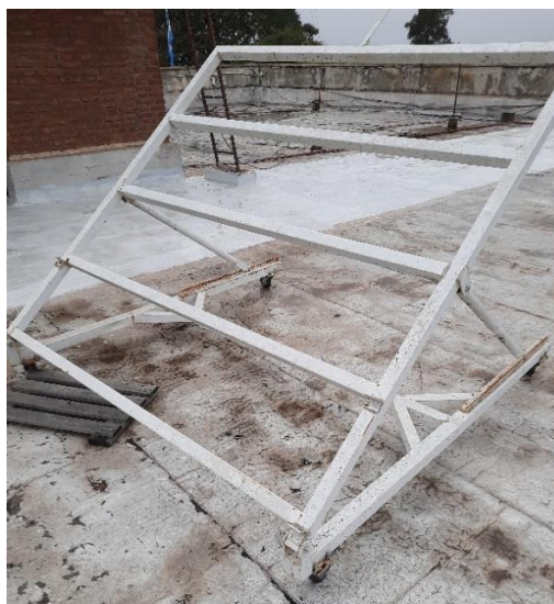
Figura 2. Plataforma ajustable para ensayos de paneles fotovoltaicos.
