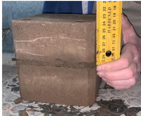
Figura 4. Probeta de BTC para ensayo a compresión.
