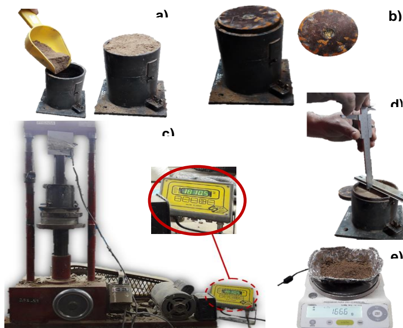
Figura 3. Procedimiento del ensayo proctor Standard adaptado.
