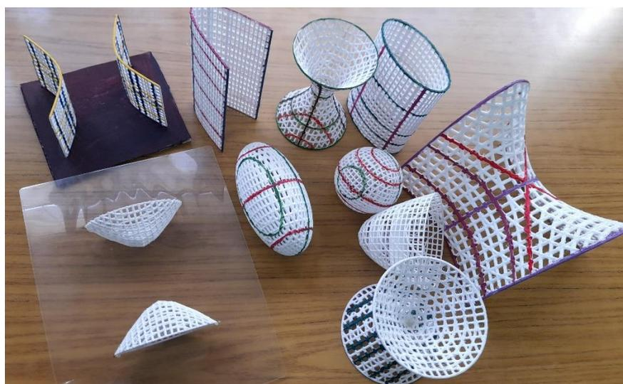
**Figura 5:** Fotografía de las superficies impresas en 3D. Diseño y elaboración propia.
