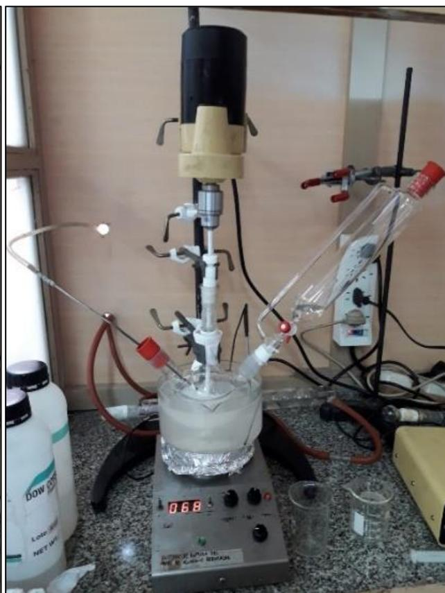
Figura 2 Reactor químico, etapa de polimerización
