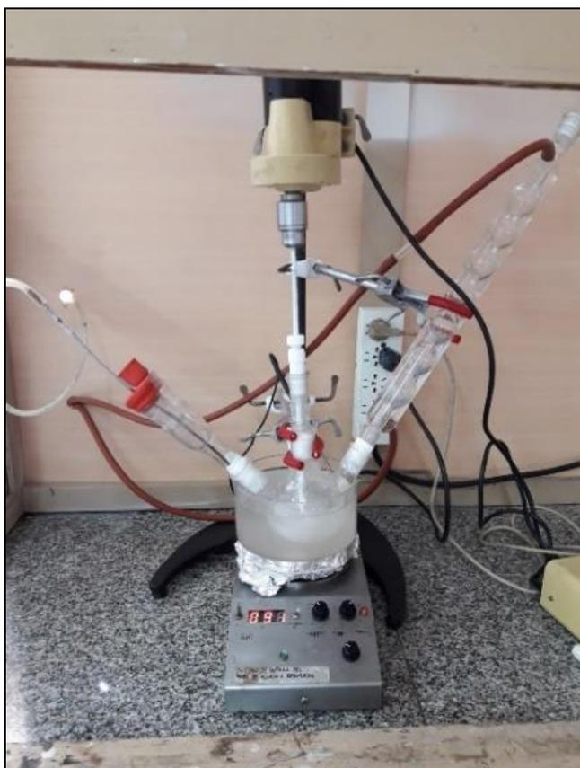
Figura 1 Reactor químico, etapa de polimerización
