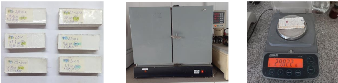
Fig. 2: a) Probetas para absorción de agua; b) Horno para quitar humedad; c) Probeta en balanza
