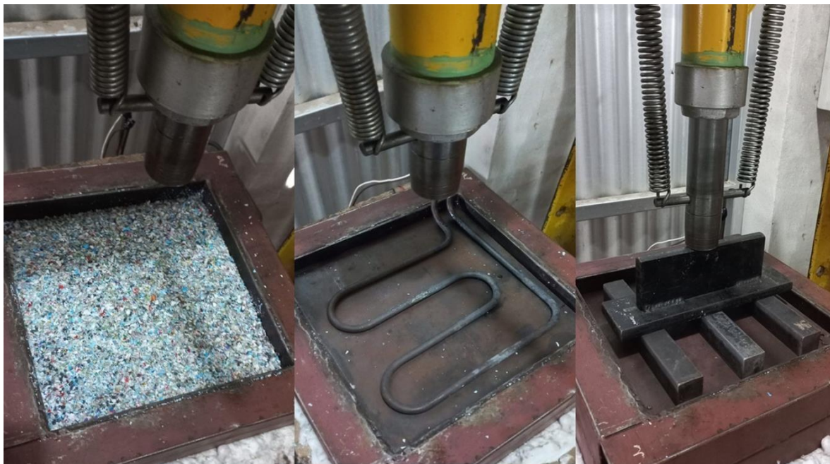
Fig. 1: Proceso de moldeo con termo compactación en prensa hidráulica de 20 t
