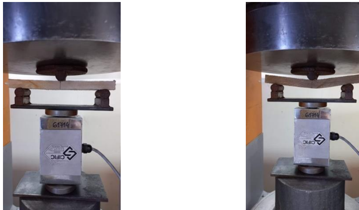
Fig. 5: a) Probeta en ensayo a la flexión sin carga; b) Probeta en ensayo a la flexión con carga
