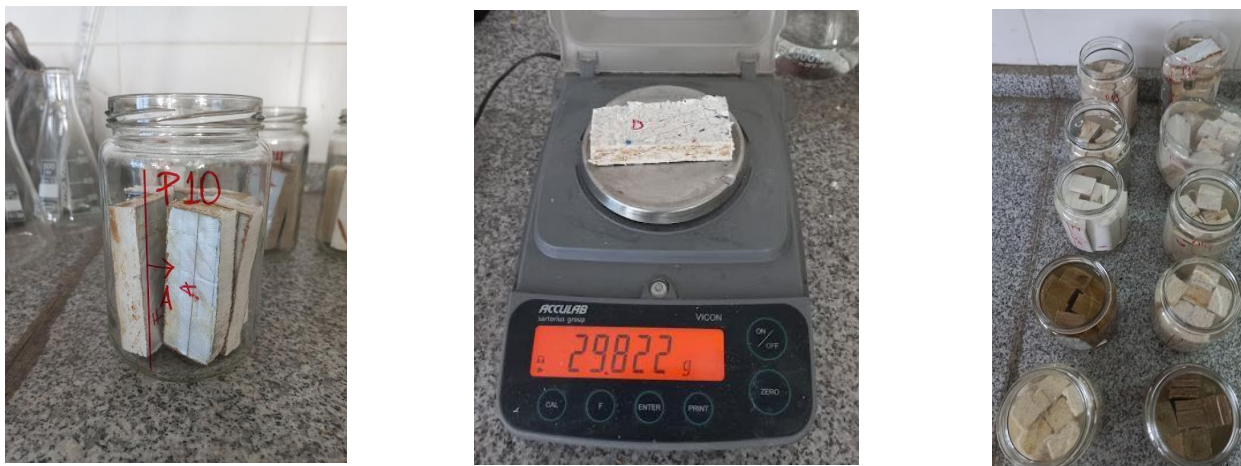
Fig. 3: a) Probetas en agua destilada; b) Registro de peso; c) Probetas sumergidas en agua destilada
