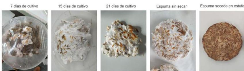
Proceso de crecimiento de material biobasado con fibra de cañamo y micelio
