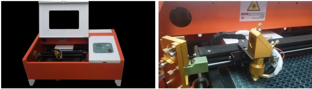
Figura 1. Láser semi industrial de 40 W y detalle boquilla de salida. Fuente: Bucci CNC.
